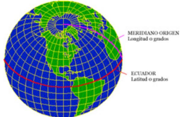
La *longitud geodésica* de un punto es el ángulo que forma con el plano del ecuador la recta que pasa por dicho punto y es normal al elipsoide de referencia.
